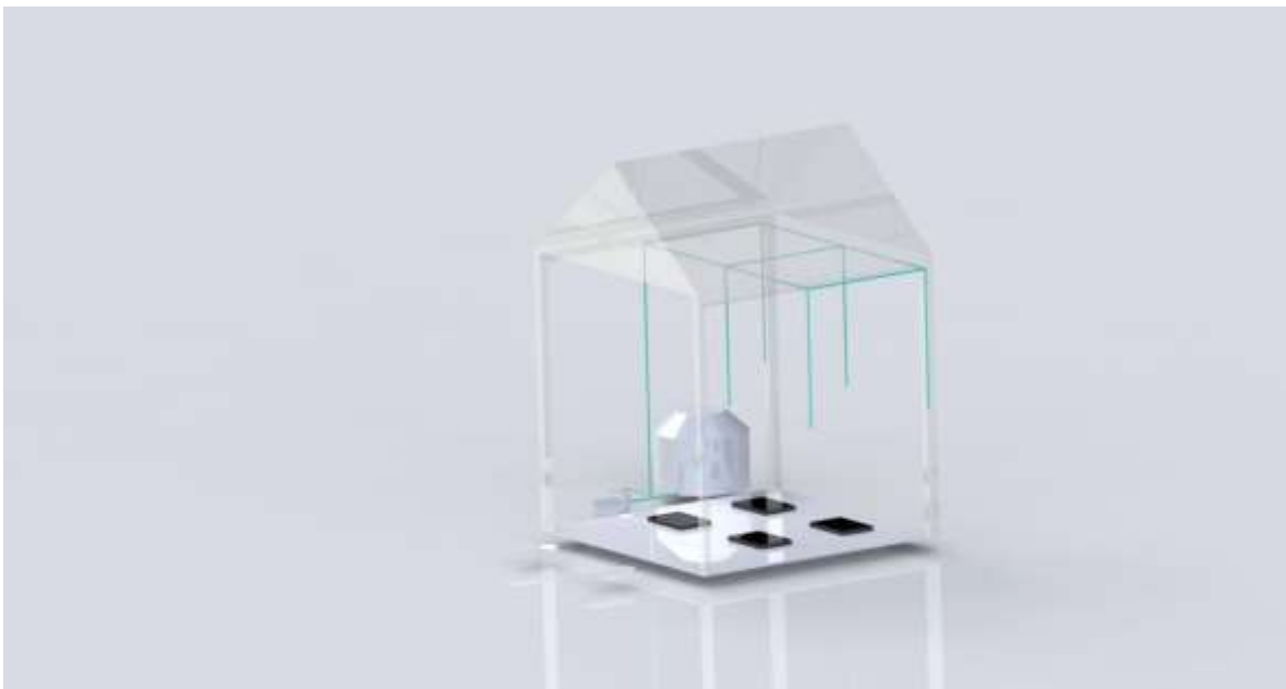
Ilustración 2 Vista esquemática de la tubería para aspersión.
